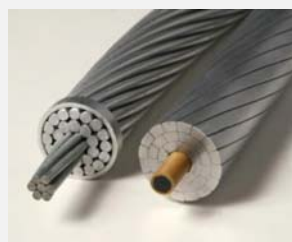
Slika 1: Usporedni presjek Al/Č i ACCC vodiča
